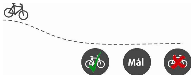
Figur 9.1: Korrekt placering af cykelparkering i forhold til mål. Grafik: Pablo Celis
