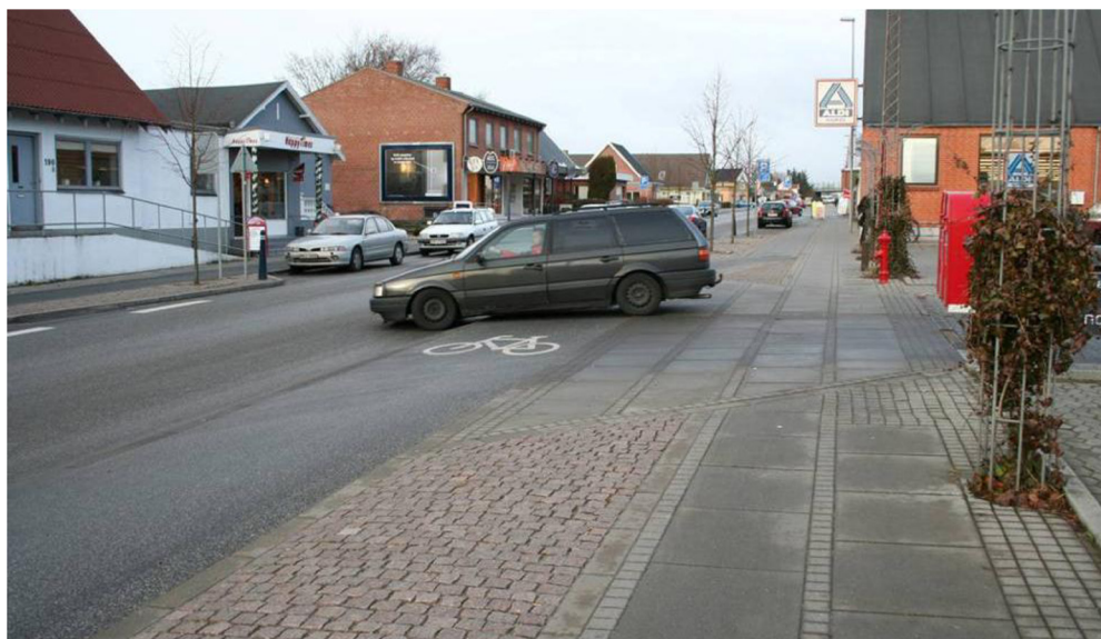
Figur 18.5: Eksempel på gennemført cykelsti / fortov over sidevej.
