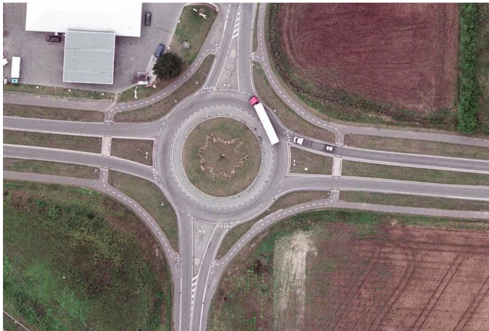
Figur 18.10: Eksempel på rundkørsel, hvor stikrydsningerne er trukket væk fra krydset. Cyklisterne er pålagt vigepligt.
